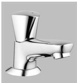
Costa S Toiletkraan metalen greep markering blauw GROHE Carbodur® keramisch bovendeel gegoten uitloop met mousseur aansluitmoer 1/2"
